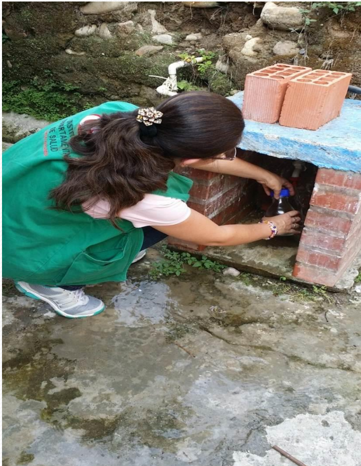
Toma de muestra de agua del sistema del acueducto municipal
